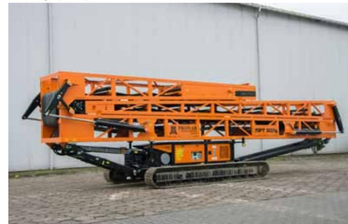
Для привода всех функций устройства используется дизельный двигатель мощностью 55,4 кВт марки **CAT stage V**
