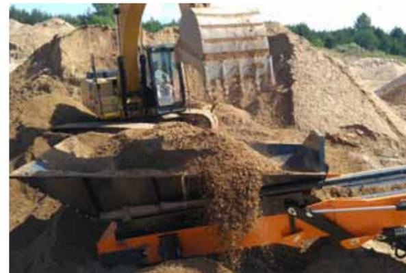
Высокая просность конвейера позволяет использовать бункер прямой загрузки 8 м<sup>3</sup> без дополнительных модификаций конвейера
