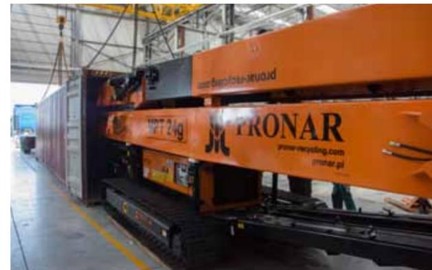
Компактная конструкция позволяет транспортировать в контейнере 40HQ
