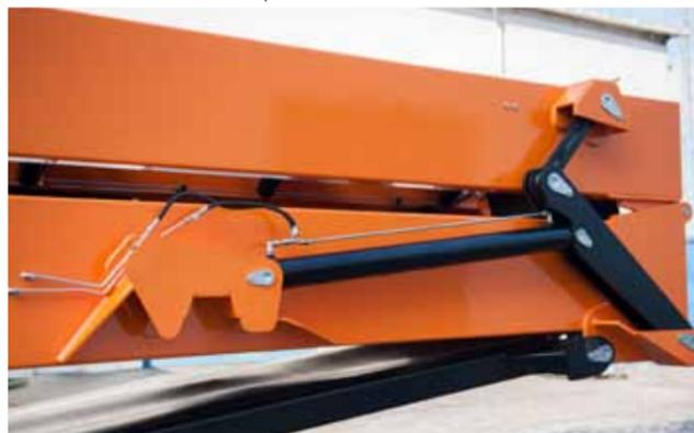
Опора на задней стороне конвейера защищает от повреждений при укладке конструкций на землю (когда не используются опорные ноги)
