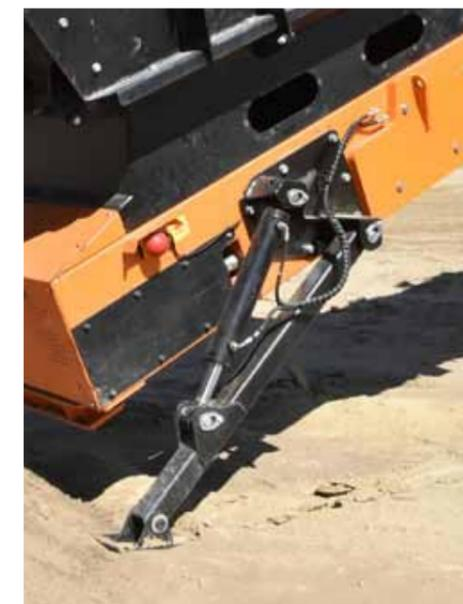
Гидравлические опоры (опция) в задней части конвейера
