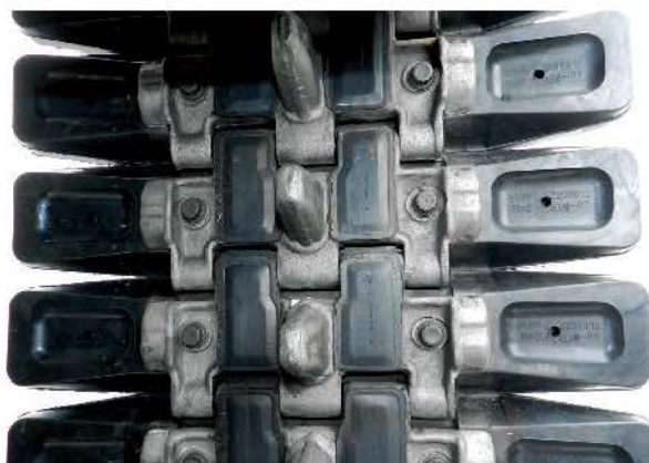
Асфальтоходные гусеницы совмещают в себе преимущества металлической резиновой гусеницы, обеспечивая устойчивость к жестким препятствиям и легкий вес.
