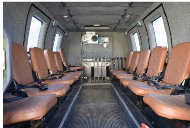
Пассажирское отделение второго звена имеет независимую систему обогрева отделения, оснащено ФВУ, комфортные сиденья на 12 чел.
