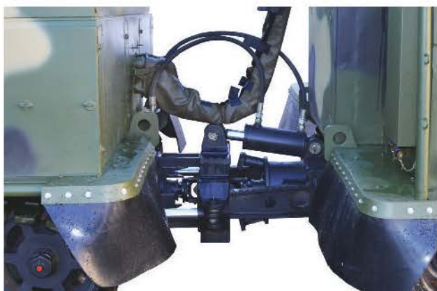
Поворотно-сцепное устройство является ключевым узлом управления машиной, придавая ей уникальные свойства по проходимости.
